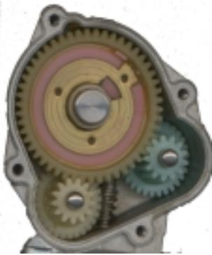
Cette solution permet d'annuler l'effort axial supporté par le guidage de la vis sans fin, celle-ci supportant deux efforts axiaux directement opposés, et accessoirement d'avoir deux dentures en prises pour augmenter le couple transmissible.
